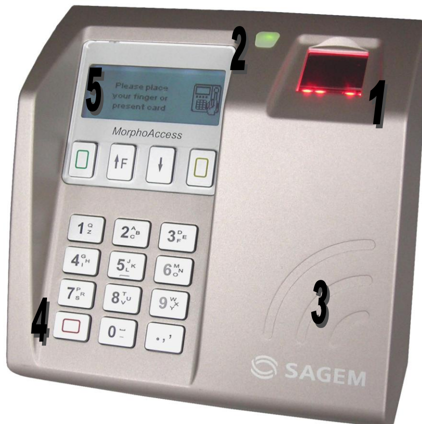
Figure 1: Face avant du terminal MorphoAccess® Série 500
